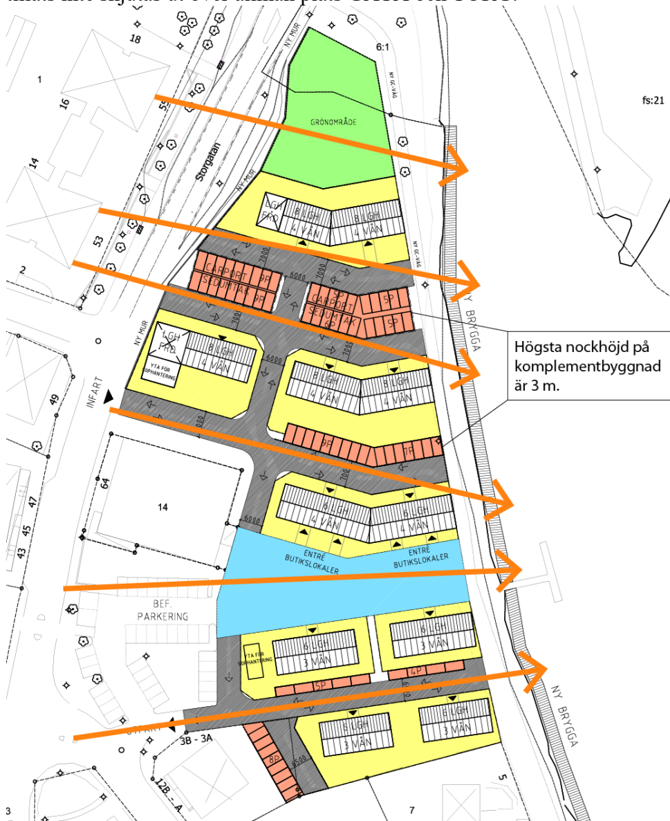
Figur 8: Siktlinjer vid exempel på exploatering enligt planförslagets reglering (Förslag: Riktningen arkitektbyrå, illustration: Tengbom).
